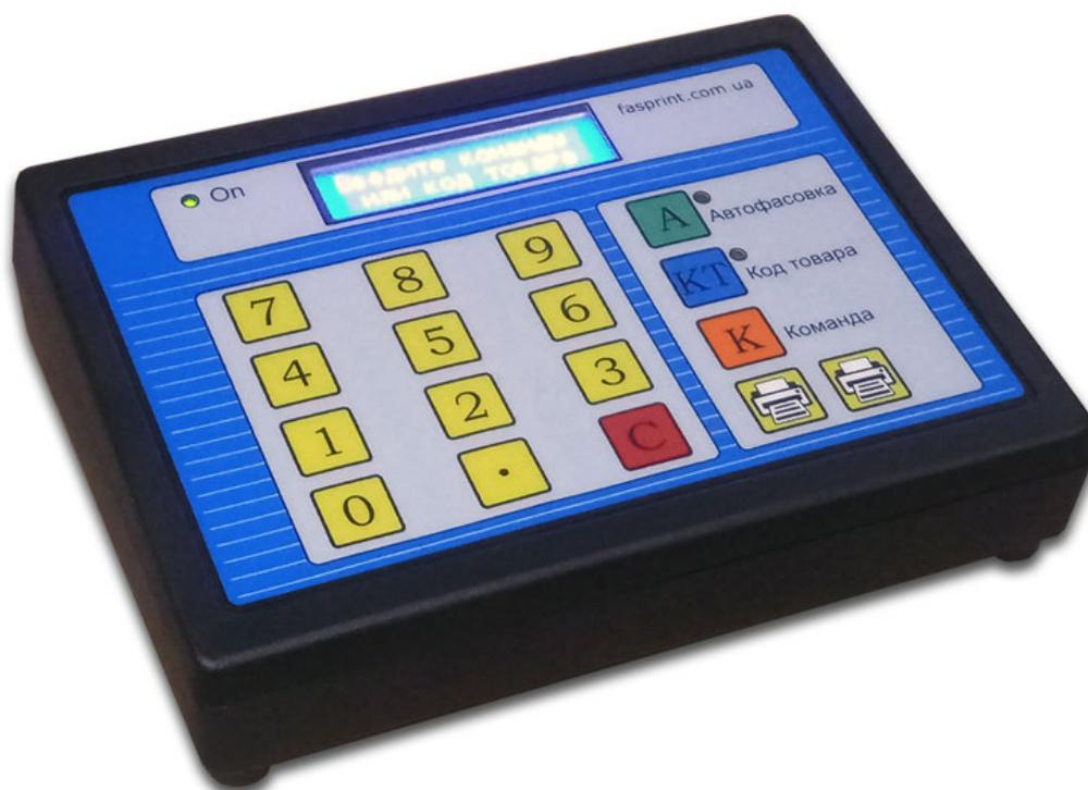
Основная функция блока управления весами и принтером этикеток (программируемой SMART-клавиатуры) Fasprint 3 USB/Ethernet (далее по тексту: **клавиатура Fasprint**) – управление весами и принтером этикеток для фасовки и маркировки продукции самоклеющимися этикетками.
